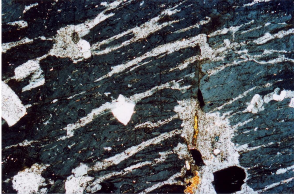
Fig. 68: Análise dos constituintes minerais de amostra do granito da Ponte de Vila Formosa. Microlina (Feldspatos tardios) (imagem obtida com nicois (lentes) cruzados).
