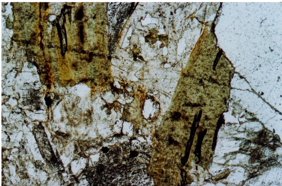
Fig. 67: Análise dos constituintes minerais de amostra do granito da Ponte de Vila Formosa. Biotites Cloritizadas (a mesma imagem, obtida sem nicois (lentes) cruzados).
