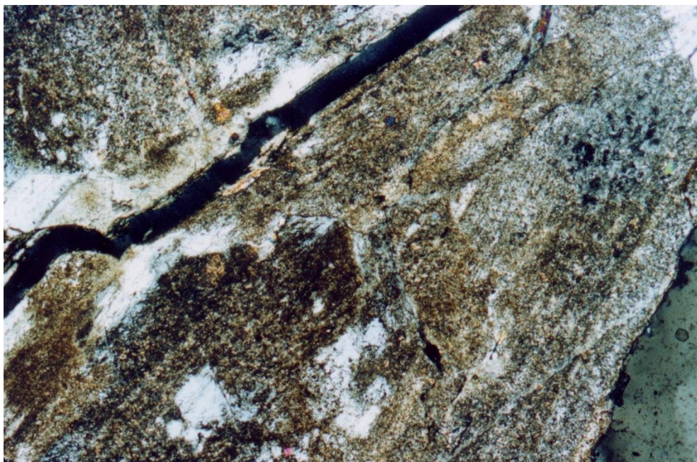
Fig. 65: Análise dos constituintes minerais de amostra do granito da Ponte de Vila Formosa. Feldspatos alterados (imagem obtida com nicois (lentes) cruzados).
